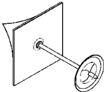
**Гвоздь изоляционный диаметром 2,7 мм с квадратным стальным оцинкованным основанием 50x50 мм в комплекте с клипсой (шайбой) диаметром 38 мм**
